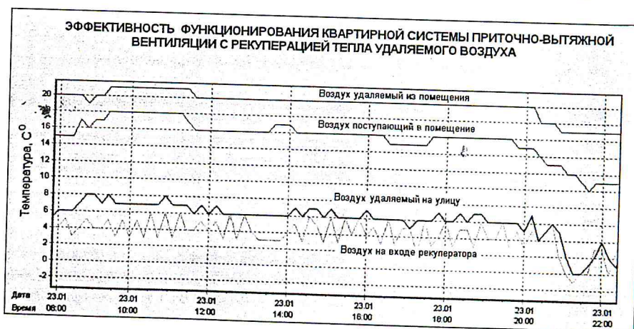
Рис. 7. Зависимость температуры в каналах рекуператора от времени
