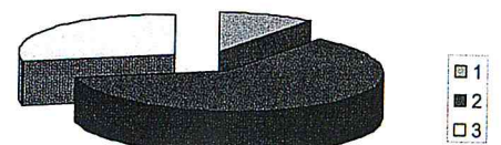
Рис. 11. Теплопотери, торцевая комната верхнего этажа, Q=175 кВт·ч/м 2 в год, R оп =2, R о =0,6: 1 – окно; 2 – ограждения; 3 – воздухообмен
